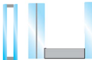
Figure 9 : Schéma d'un vitrage isolant double de type 4/16/4 (à gauche) et 44.2/12/4 (à droite)
